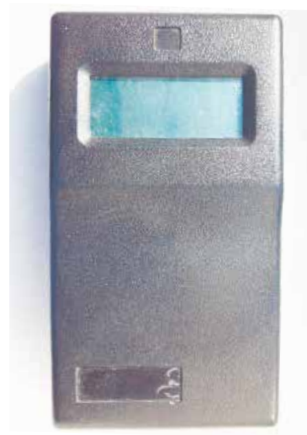
Рисунок 3. Прибор, фиксирующий мерцание источника света
