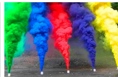
Рис. 4. Дымовые шашки для определения движения потоков воздуха
