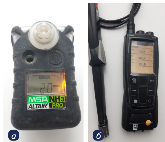
Рис. 6. Мобильные газоанализаторы: а — компактный анализатор \text{NH}_3 ; б — комплексный прибор с фиксацией содержания \text{CO}_2
