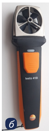
Рис. 3. Анемометры с разными типами чувствительных элементов: а — струна; б — крыльчатка
