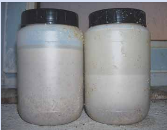
Фото 1. Если частицы не будут плавать достаточно долго, есть все шансы, что они осядут в трубах, и не во все кормушки попадет одинаковое количество сухого вещества
