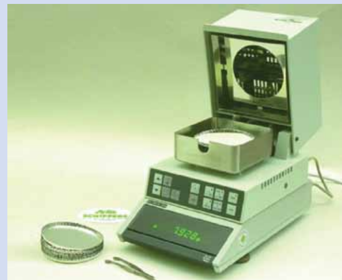
Фото 3. Нет необходимости сдавать образцы в лабораторию. Для определения сухого вещества в течение 20 минут есть полностью автоматические аппараты.
