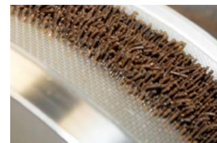
Рис.5. Матрица пресс-гранулятора с отверстиями диаметром 2,2 мм
